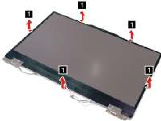
Figure 28. Remove the LCD bezel
