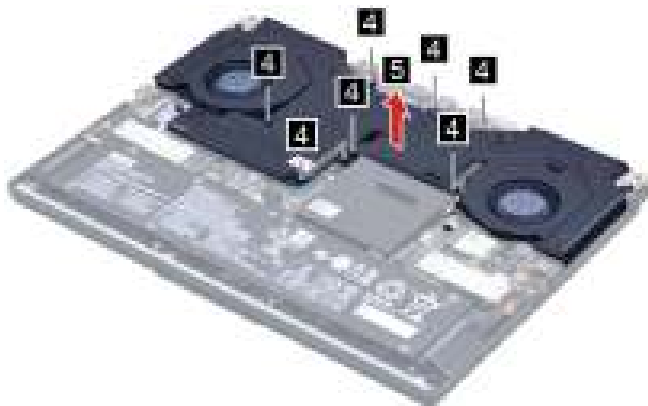
Figure 23. Remove the thermal module
