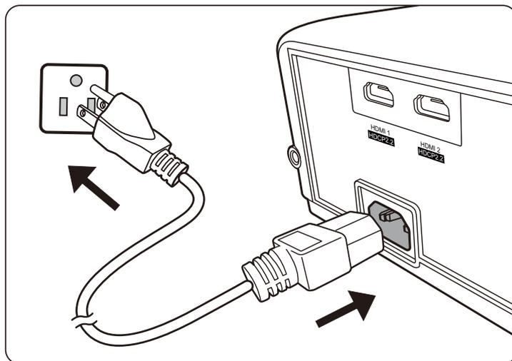
**REMARQUE :** Lors de l'installation du projecteur, incorporez un dispositif de déconnexion facile accessible dans le câblage fixe, ou connectez la prise d'alimentation à une prise secteur facilement accessible à proximité de l'unité. En cas de problème pendant l'utilisation du projecteur, utilisez le dispositif de déconnexion pour interrompre l'alimentation, ou déconnectez la prise d'alimentation.
