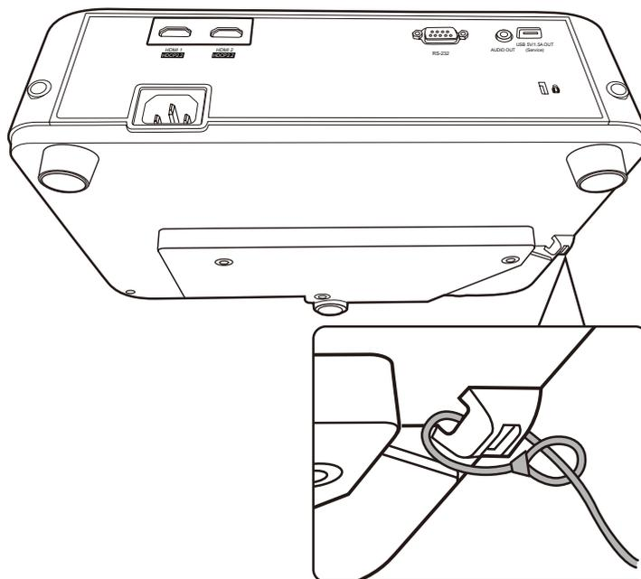
**REMARQUE :** La fente de sécurité peut également servir d'ancrage de sécurité si le projecteur est monté au plafond.
