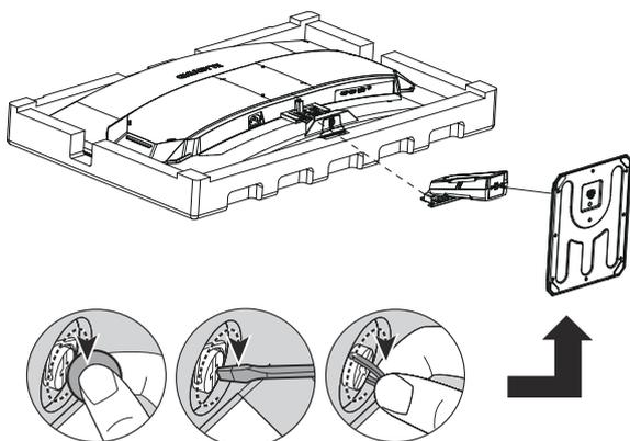
3. Déchirez l'emballage en polystyrène. Installez la colonne de la base sur la rainure à l'arrière du moniteur. Poussez le support jusqu'à ce qu'il s'emboîte en place.
