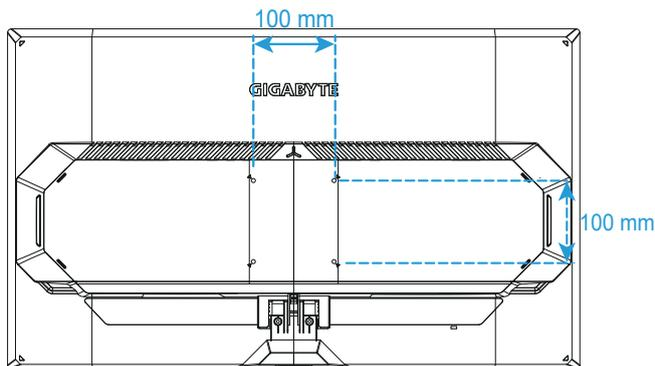
**Remarque :** Pour monter le moniteur sur un mur, reportez-vous au guide d'installation inclus dans le kit de fixation murale. Quantité nécessaire de vis de montage VESA : 4, taille de vis : M4 x 10 mm minimum.
