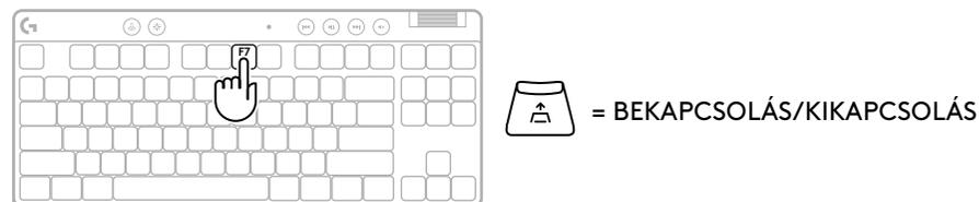
**4** A nyílbillentyűkkel növelheti vagy csökkentheti a Rapid Trigger érzékenységet. A megfelelő szám megnyomásával közvetlenül is kiválaszthatja a kívánt értéket (pl. „2” a 0,3 mm-hez).
