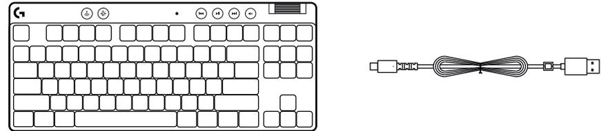
**2** Conecta el cable *USB-C* al puerto situado en la parte frontal del teclado.
