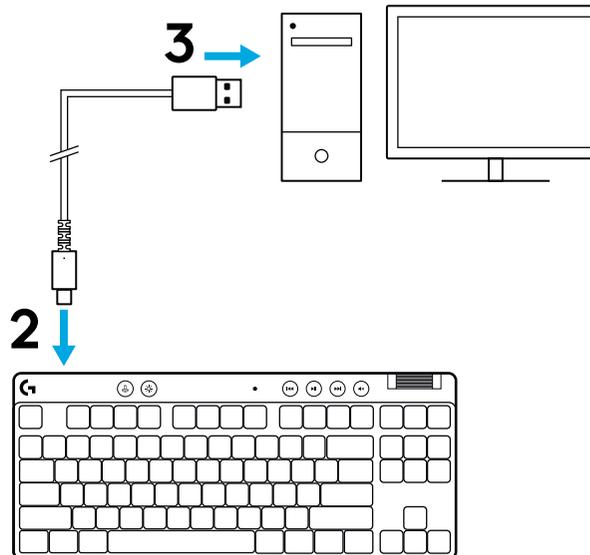
**3** Koble kabelen til PC-en din.
