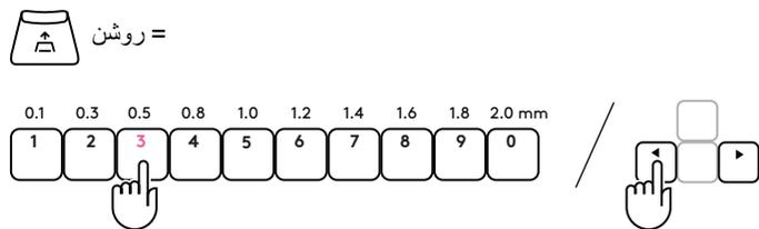
برای تست تنظیمات حساسیت فعلی، یکی از کلیدهای الفبا را فشار دهید. هنگام فشار دادن و رها شدن، چراغ کلید در زمان فعال‌سازی آبی و هنگام بازنشانی سرخابی می‌شود.
