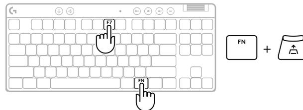
**3** Pritisnite F7 da biste omogućili uključivanje/isključivanje brzog okidača.
