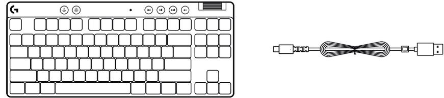
**2** Utaknite *USB-C* kabel u priključak na prednjoj strani tipkovnice.
